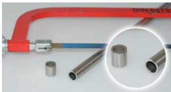
Resultado sierra de arco (rebaba exterior e interior)
