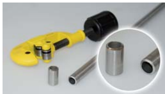
Resultado cortatubos (rebaba interior)
